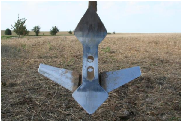
Verstellbare Flügel an einer Doppelherz-Grubberschare; Bild: TU Dresden
