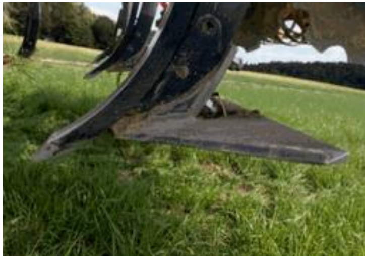
Erhöhter Selbsteinzug durch Kombination von Grubberspitze und Flügelschare; Bild: Horsch
