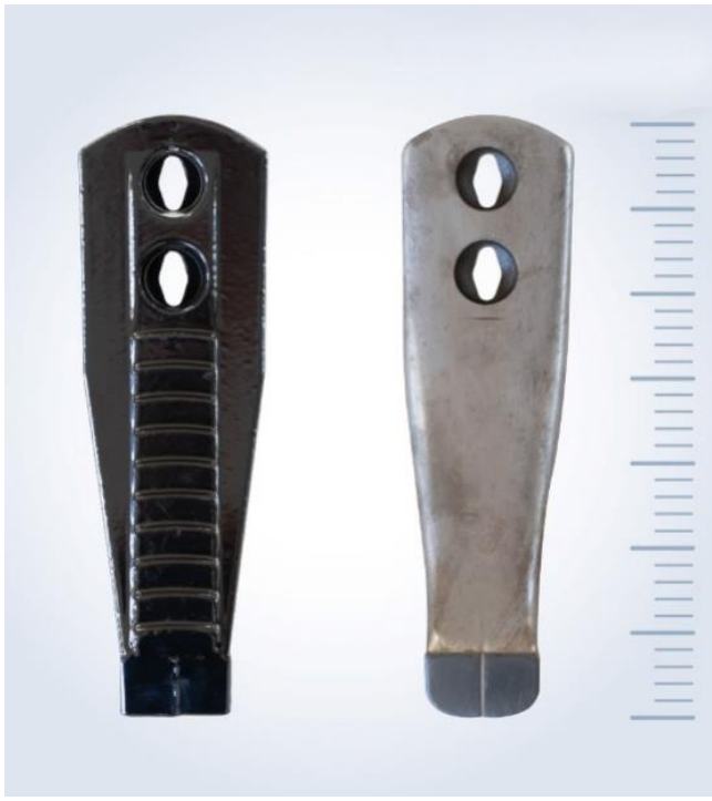
Neue und verschlissene Grubberzinke mit aufgelöteten Hartmetallblättchen an der Spitze; Bild: PÖTTINGER
