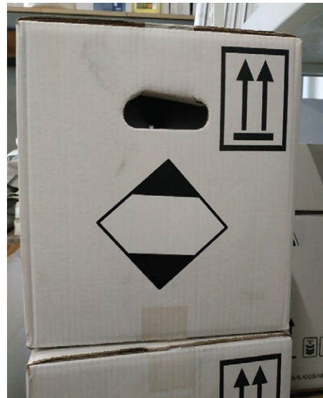
Abb. 8: Wird die Beförderung von begrenzten Mengen (nach 3.4 ADR) beansprucht, müssen die Versandstücke mit dem Kennzeichen „Raute mit schwarzen Ecken“ und ggf. mit den Ausrichtungspfeilen „oben“ versehen sein.
