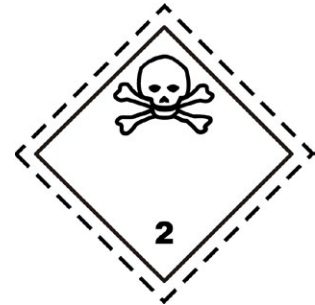
Abb. 3: Beispiel eines Gefahrzettels für eine Gefahr der Klasse 2 (giftige Gase).
