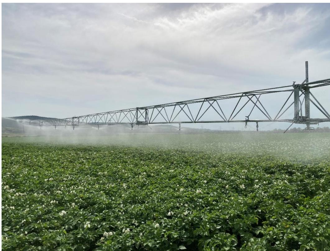
Ein Düsenwagen (Fa. Beinlich) über einem Kartoffelfeld, das System ist kombiniert mit einer Trommelberegnungsanlage „RainStar“ (Fa. Bauer)
