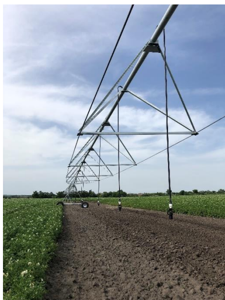
Pivot-Bewässerungsanlage am Gut Hardegg, Foto: Simon Wirkert, ÖKL
