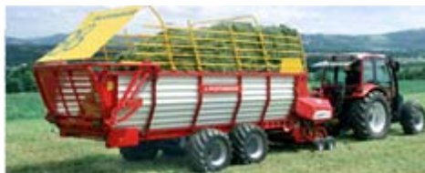
Erntekette mit Kurzschnittladewagen
