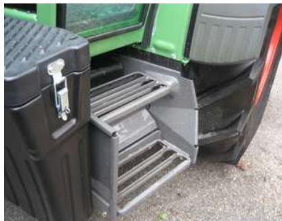
Vorstehende Kanten, Verletzungsgefahr
