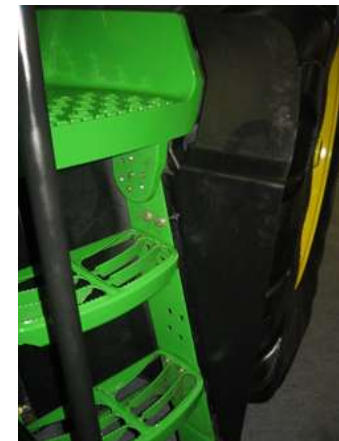
Trittstufen vor Verschmutzung geschützt, austauschbar
