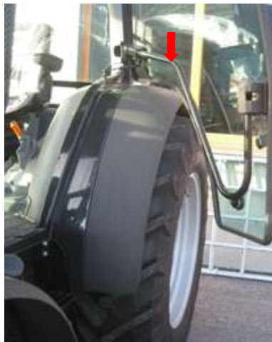
Handlauf Stufenverlauf folgend
