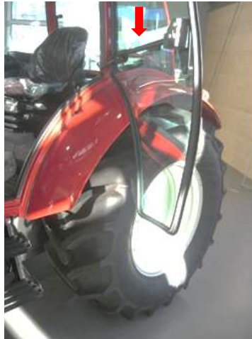
Handlauf nicht Stufenverlauf folgend
