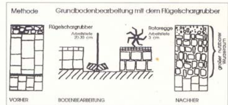
Abb. 15: Nichtwendende Lockerung der Unterkrume mit Schichten- oder Rotorgrubber
