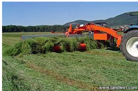
Abbildung 1. Bandschwader in Arbeitsstellung (links oben), Transportstellung (links unten) und beim praktischen Einsatz.
